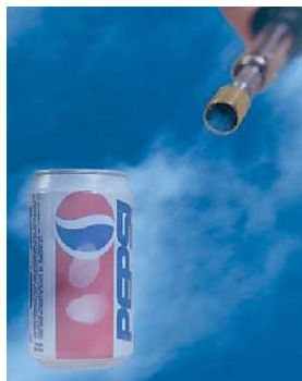
Рис. 11. Виявлення слідів пальців рук методом окурювання парами ціаноакрилу з використанням газового пальника
