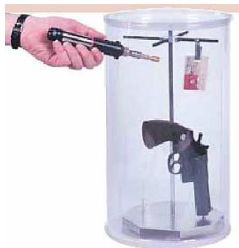
Рис. 10. Поліетиленова камера для обробки об'єктів парами ціаноакрилу з використанням газового пальника
