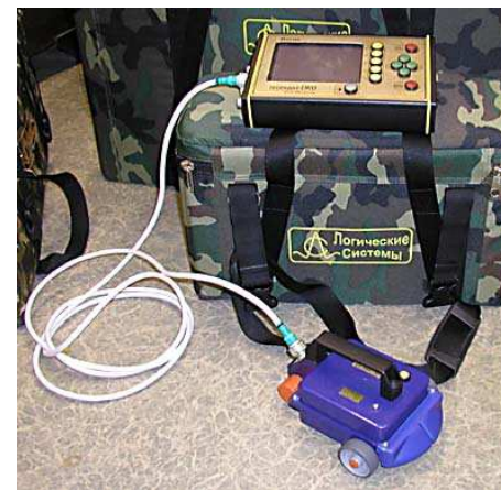
Рис. 2. Геологічний радар типу «ОКО» с антенним блоком АБ-1700 і блоком обробки як регістратор сигналу.
