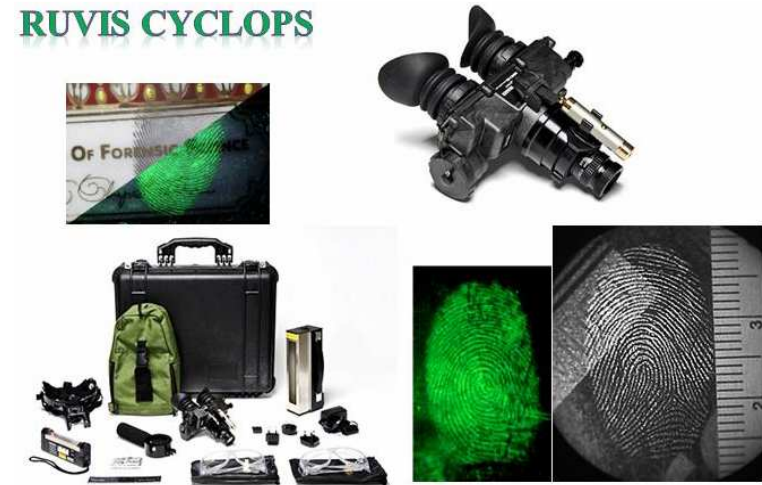
Рис. 3. Система RUVIS CYCLOPS для візуалізації слідів без попередньої їх обробки.
